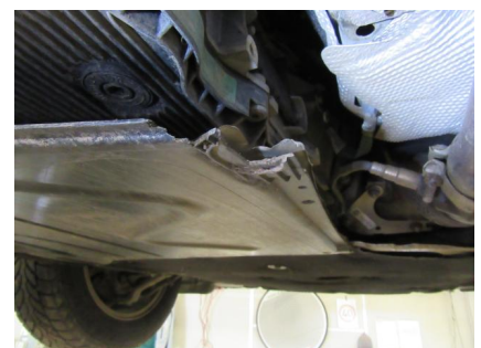
Fahrzeugunterseite Unterfahrschutz (Getriebe) beschädigt - erneuern
