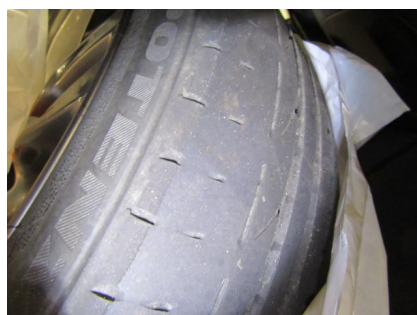
Rad vorne links Reifen einseitig abgefahren - erneuern
